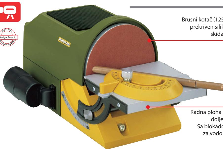
Brusni kotač (125mm) izrađen od lijevanog aluminija, prekriven silikonskim filmom koji omogućuje lako skidanje brusnog papira nakon upotrebe.
