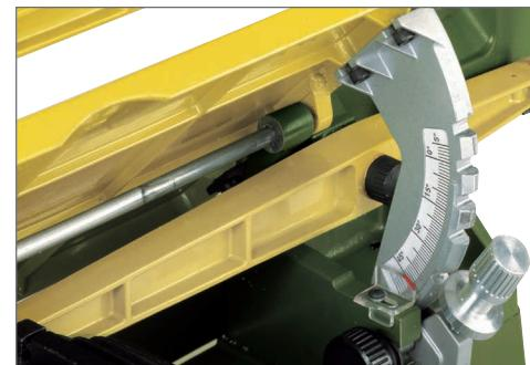
**Inovativnost u rješavanju problema (patentirano):** za lakšu zamjenu listova pile moguće je vodoravno postavljeni stol otpustiti i pomažući za oko 80mm. Na taj način dobiva se jasna vidljivost prije svega donje ruke pile kod postavljanja držača lista pile ili lista pile sa zatikom.
