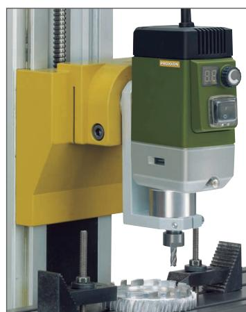
Za korištenje s MICROMOT rotirajućim alatima velike brzine u kombinaciji sa serijom glodalica FF 500/BL.
