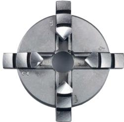
Koristi se za sticanje cilindričnih, kvadratnih ili osmerokutnih radnih komada. Visoka točnost. Raspon sticanja s reverzibilnim čeljustima od 1 – 20 mm (iznutra) i 20 – 50 mm (izvana). Ø 50 mm.
