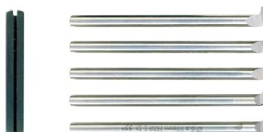
Po jedno glodalo za 60° metričke i 55° colne unutarnje navoje. 1.3mm – 2.65mm i 4mm. Drška promjera 6mm, duljine 95mm. Glodala drži držać alata (8 x 8mm) koji se montira na PD 230/E, PD 250/E ili na PD 400. Dolaze u drvenoj kutiji s kliznim poklopcom.
