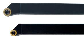
Držać pod kutom ulijevo za 45° za cilindrične umetke od volframovog karbida Ø 6mm. Za izuzetno visoku kvalitetu površine i malu hrapavost površine, za radijuse okretanja i rezanje okruglih utora. Set uključuje dva umetka od volframovog karbida, dva pričvrsna vijka za umetak i TX 8 ključ.
