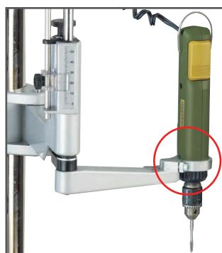
MIS 1 je idealan za rezanje navoja zbog prekidača uključeno/isključeno/obrnutu i okretne brzine od 250 okr./min. Rezač navoja je precizno vođen što osigurava točne i okomite unutarnje navoje .
