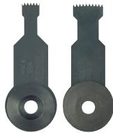
Za točno izdubljivanje četverokuta. Za izradu grotla i prozora u modelima broda i zrakoplova. Reže drvo, šperploču, plastiku i aluminij. Maks. dubina uranjanja 16mm.
