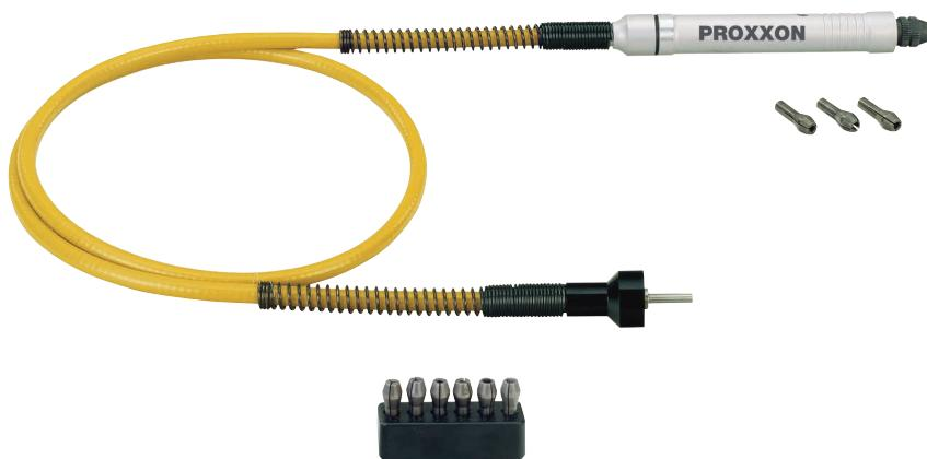
Osovina od vučenog čelika sa dvostrukim kugličnim ležajevima i držaćem priključnog alata za MICROMOT stezne čahure. Kuglični ležaj na kraju osovine. Izrazito savitljiva jezgra (ne pregrijava se pri radu pod malim radijusima). Duljina 100cm. Za maksimalno 25.000 okretaja. Uključeno 6 steznih čahura (1 – 1.5 – 2 – 2.4 – 3 i 3.2mm).
