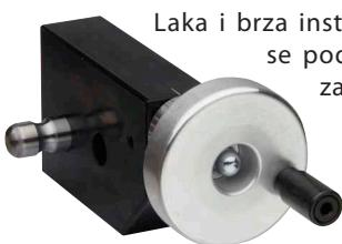
Laka i brza instalacija. Pomak vretena može se podešavati bilo pomoću kotača za vertikalni posmak (visine) ili kotača za fini posmak. Kotač za podešavanje ima skalu sa podjelama od 0.025 uz mogućnost podešavanja 0. 1 podiok = 0.05mm.
