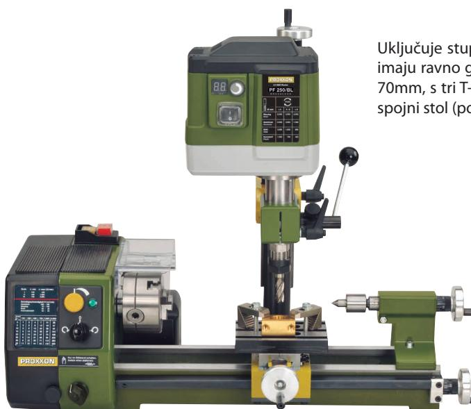
Uključuje stup (35 x 400 mm), montažnu konzolu i pričvrsne vijke (PD 250/E i PD 400 već imaju ravno glodano površinu). Umjesto nosača alata, odgovarajući stol s T-utorima (110 x 70mm, s tri T-utora 12 x 6 x 5mm) pričvršćen je na gornji klizač. Tokarilica sada zamjenjuje spojni stol (podešavanje preko uzdužnog posmaka i poprečnog klizača).
