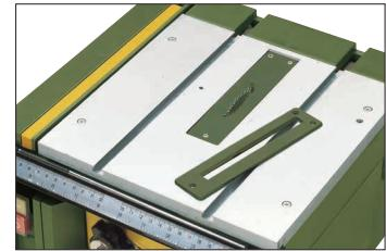
Poklopac otvora lista pile od ABS-a za usku toleranciju između lista pile i radne plohe (prorezan sa donje strane listom pile FET stroja). Za rezanje izravno malih komada.
